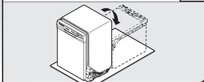
**Conseil :** Pour protéger le sol, laisser une feuille de carton sous le lave-vaisselle jusqu'à son installation dans la cavité d'encastrement. Ne pas utiliser le panneau de porte comme surface de travail sans d'abord l'avoir recouvert d'une serviette pour éviter de l'endommager.
